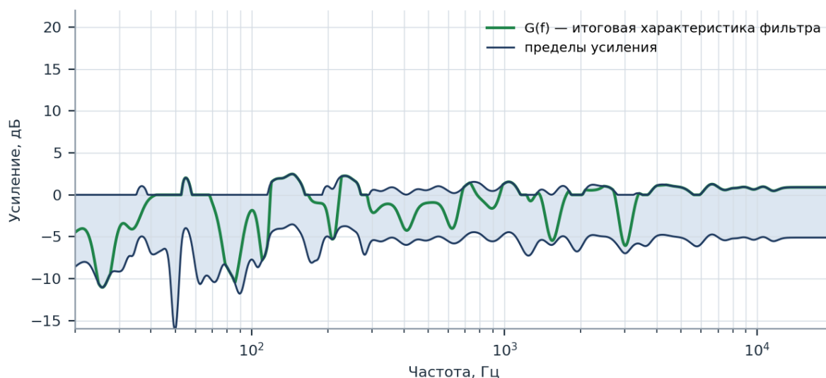
Рис. 4. Итоговая характеристика G(f) : там, где H_{\text{focus}} укладывается в коридор, он проходит без изменений; за пределами коридора — усечение по границе.
