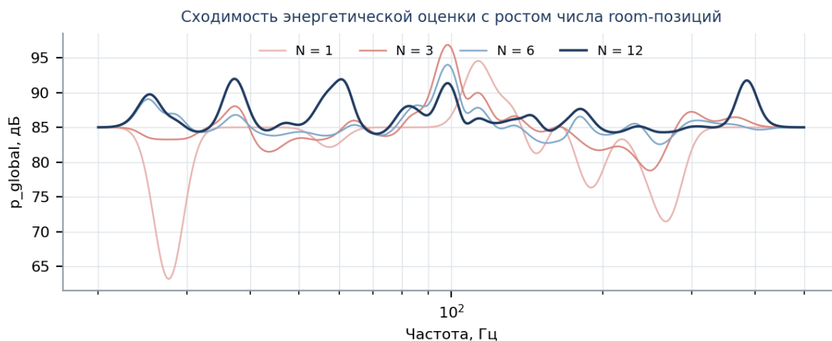
Рис. 13. Дополнительная иллюстрация, которой в докладе нет: как энергетическая оценка стабилизируется с ростом числа позиций. При N = 1 кривая ещё несёт частные особенности конкретной точки; к N \approx 6 \dots 12 остаётся общая энергетическая картина комнаты — именно она и годится для построения границ усиления.
