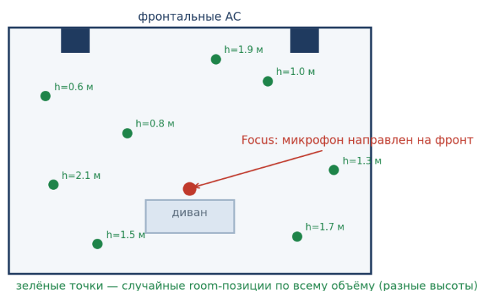
Рис. 9. Схема калибровки: одно Focus-измерение в кресле с микрофоном, направленным на фронт, и случайные room-позиции, распределённые по всей длине, ширине и высоте помещения.
